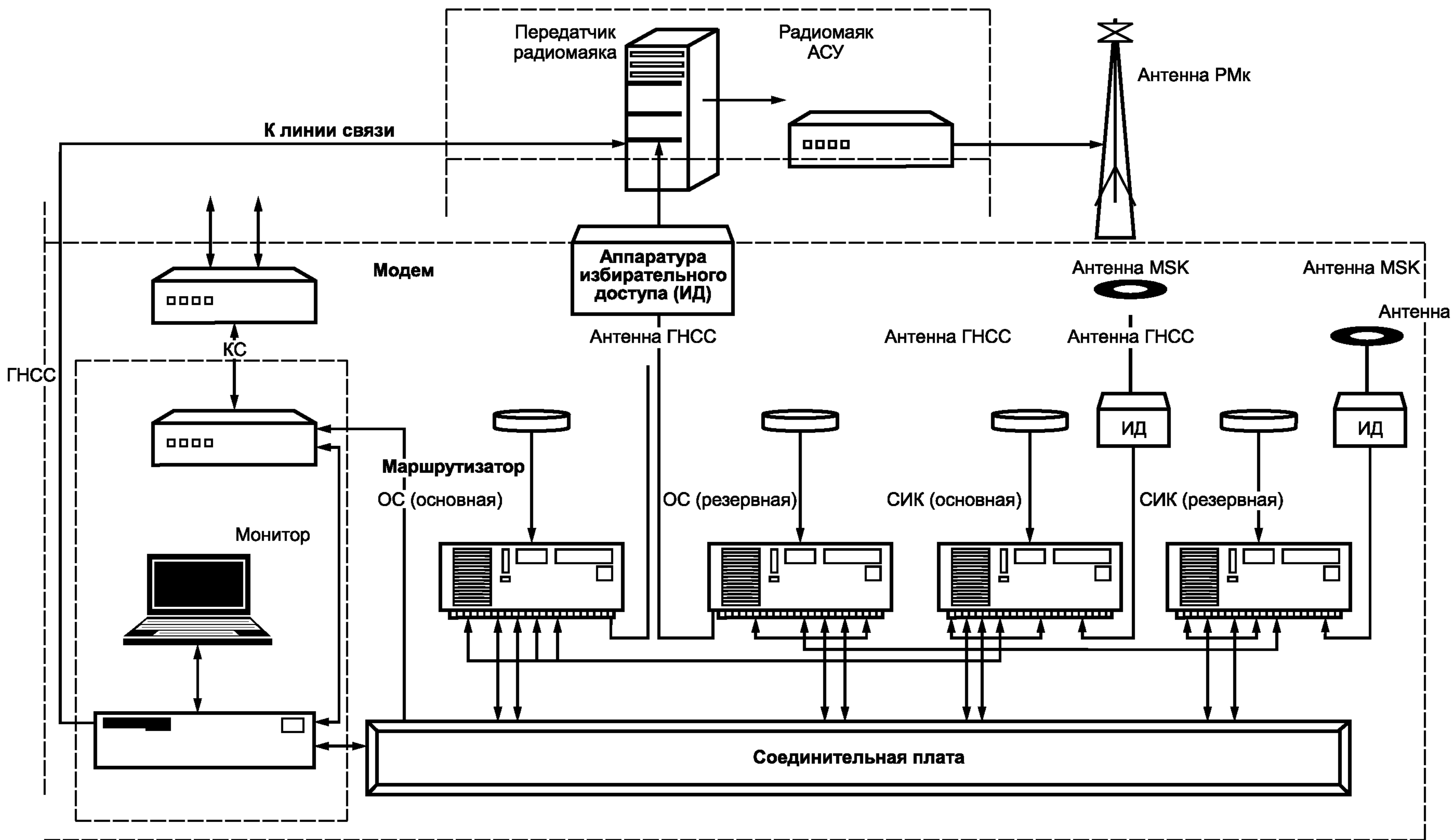
Рисунок 1 — Контрольно-корректирующая станция дифференциальной подсистемы ГНСС ГЛОНАСС/GPS
